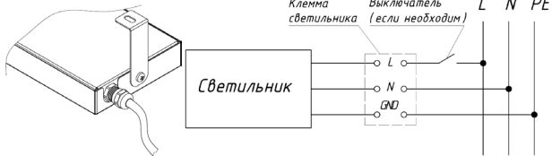
Рисунок 5. Схема подключения светильника.
